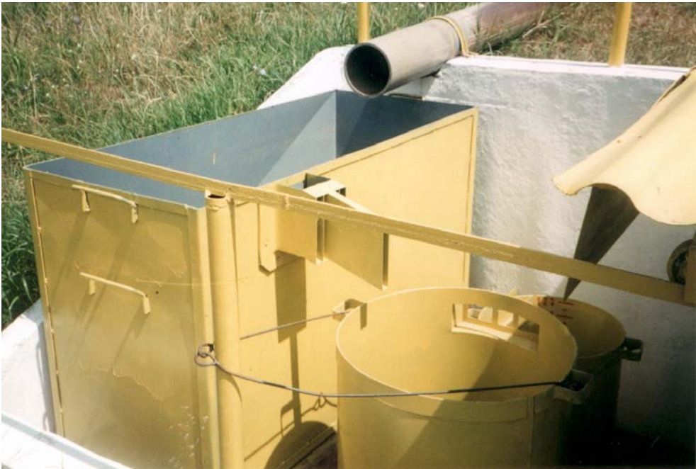
Foto 3.2. S.C.C.C.E.S. Perieni – Parcelele standard pentru controlul scurgerilor – bazinele colectoare
