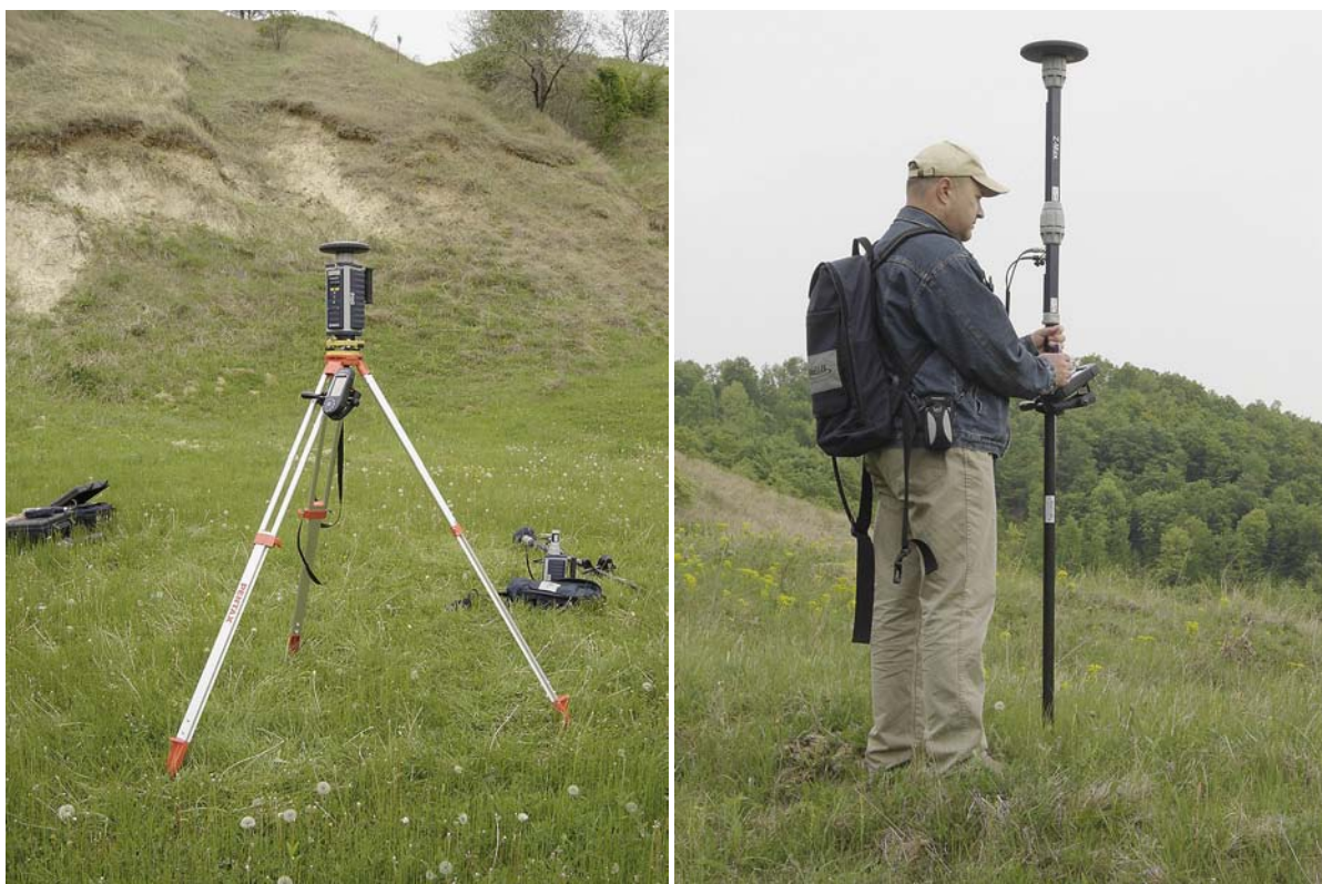
Echipamentul GPS profesional Magellan Thales Z-Max.Net format din două receptoare GPS, unul bază și altul mobil - “rover”
